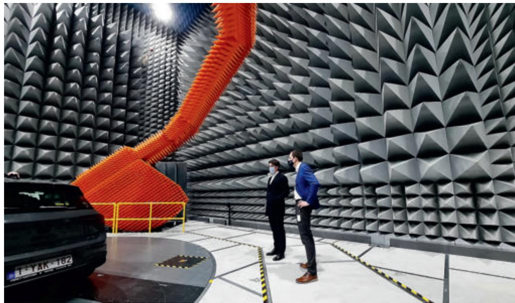
■ Une chambre anéchoïque (sans écho) pour tester et mesurer les antennes, ici sur une voiture. © VAN KASTEEL
