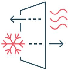
FINEO Isolierglas fühlt sich viel wärmer an als herkömmliches Einfach- oder Doppelglas. Warum? Durch FINEOs extrem guten U-Wert ist die innere Scheibe wärmer, was wiederum Zug und kalte Strahlung minimiert.
