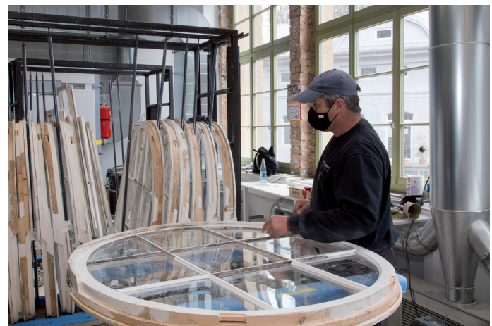
Ein historisches Rundfenster wartet auf die Ausglasung der alten Scheiben.
